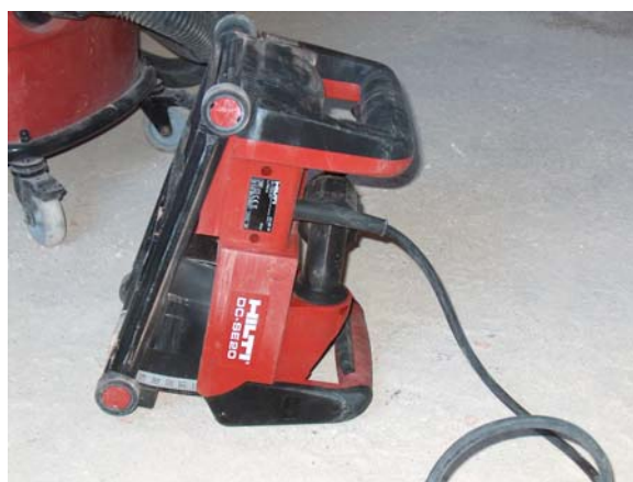
Scanaltrice e impianto d'aspirazione particolare sul sistema di funzionamento e appoggio dell'attrezzo alla superficie
